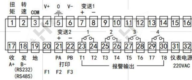
注：为了减小电源电流对测量影响，建议电源地与输入信号地在传感器端短接。
